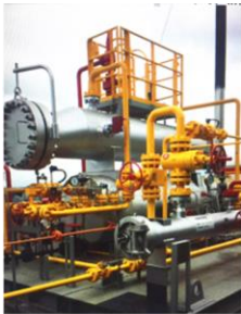
黄龙 009-H1 井高含硫地面工艺撬装化设备
